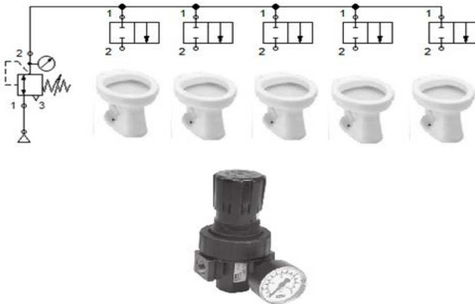
Figura 1.1 – Representação das louças na bancada de sistema de colagem.
